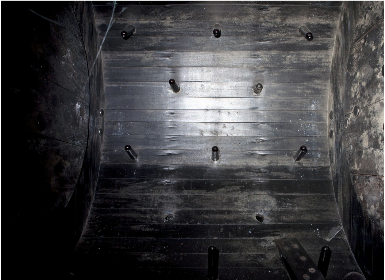
vue Intérieure du tonneau-foulon doté de picots en verre.
