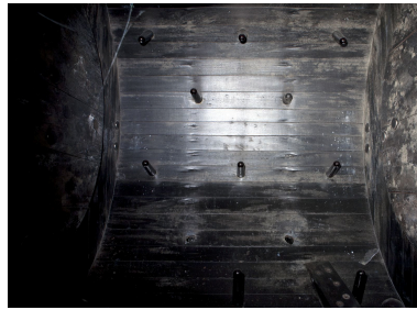
vue Intérieure du tonneau- foulon doté de picots en verre. Phot. Philippe Rivière IVR74_20138700547NUCA
