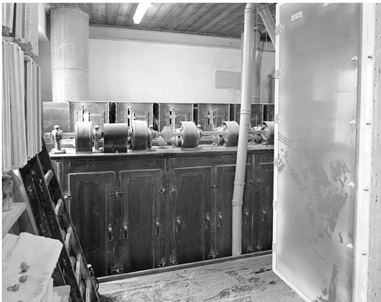
Deuxième étage de l'atelier de fabrication : vue du filtre de sûreté dans lequel la farine est entraînée par une vis sans fin.
