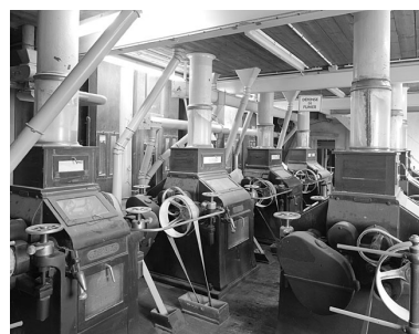
Rez de chaussée de l'atelier de fabrication : les appareils à cylindres. Phot. Marc Deneyer IVR54_19961700589V
