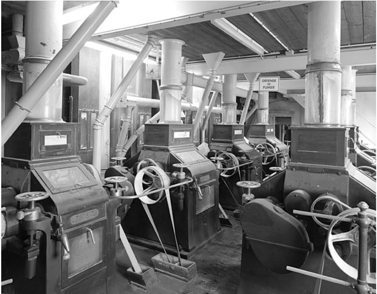
Rez de chaussée de l'atelier de fabrication : les appareils à cylindres.
