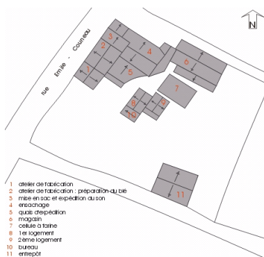
Plan schématique de la minoterie avec la répartition des différentes salles. Dess. Zoé Lambert IVR54_19961709006NUDA
